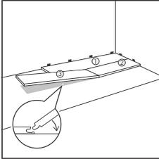
Puis, levez la lame nouvellement installée à un angle de 20 à 30°.
